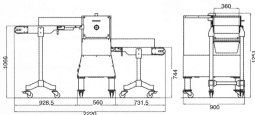
El producto cortado en filetes queda compacto, permitiendo su envasado en un único trozo precortado. El espesor de los filetes puede variar entre los 6 y 50 mm, sustituyendo de manera simple y fácil el conjunto de cuchillas.
